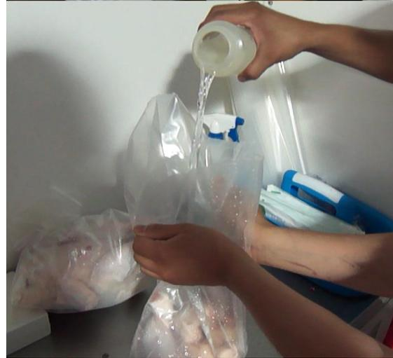
6. Manteniendo la parte superior de la bolsa ligeramente abierta, vacíe en su interior los 400 mL de APT estéril. Parte de la APT se debe verter dentro de la cavidad de la carcasa.
