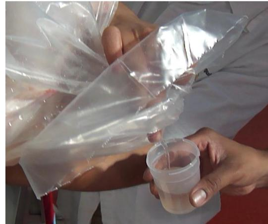
13. Con mucho cuidado abra la bolsa que contiene la carcasa. Con una mano mantenga la carcasa dentro de la bolsa por las extremidades inferiores. Con la otra mano tome la parte superior de la bolsa y vacíe lentamente el fluido obtenido del enjuague.
